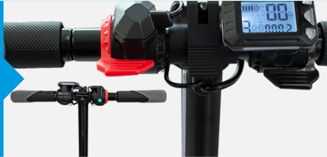
**¡Frena!** En algún momento tendrás que bajar la velocidad, el Kick Scooter cuenta con freno electromagnético en la rueda delantera y freno mecánico en la rueda trasera.
