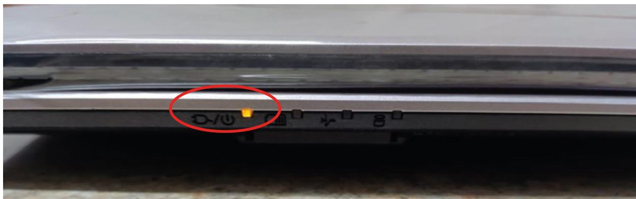
**Imagen 1** LED indicador de conexión eléctrica
