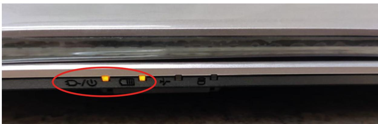
**Imagen 2** LED indicador de conexión eléctrica y LED de carga de la batería
