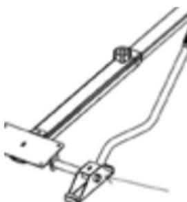
2. Remueva la tuerca pre-enroscada del eje trasero y retire 1 de las 2 rondanas de goma. Coloca la palanca de control sobre el eje trasero, inserte la rondana previamente removida y asegúralo con la tuerca de seguridad.
