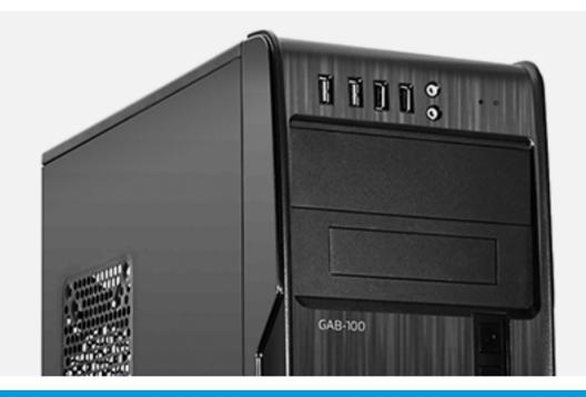
**Fácil.** Gracias a sus 4 puertos frontales USB2.0 y conectores de audio de 3.5 mm ya no tendrás que alcanzar la parte trasera de tu gabinete para conectar tus accesorios.
