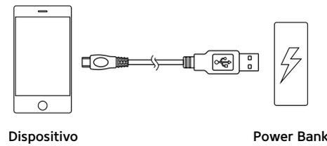
Conectar el cable con la terminal USB a la toma del Power Bank, el otro lado del cable con la terminal Micro USB se conecta al dispositivo.
