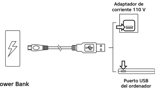
1. Conecta el Power Bank al cable USB con el adaptador de micro USB en primer lugar y luego el cargador USB debe conectarse a la electricidad.
