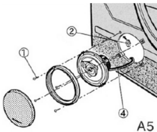
Para finalizar coloque la malla de protección con el aro de seguridad.
