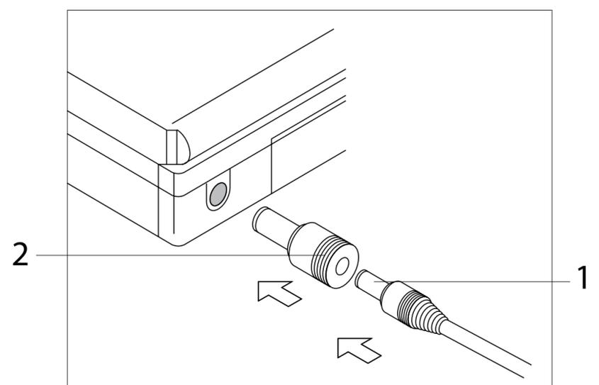
1.- Conector cable de salida de corriente directa
